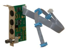
Das Synchronisationseingangsmodul ist für die Montage in einem kurzen Gehäuseslot geeignet.
