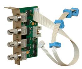
Das Synchronisationsausgangsmodul ist für die Montage in einem kurzen Gehäuseslot geeignet.
