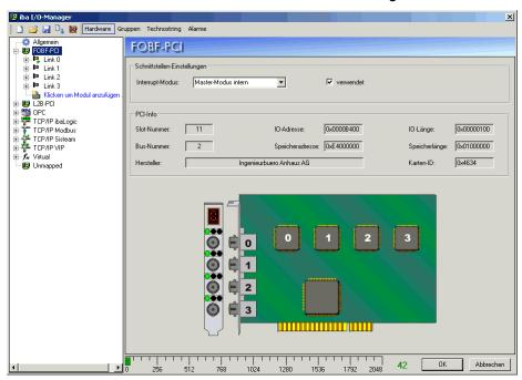
Die entsprechende Baugruppe wird schematisch in dem Dialogfenster dargestellt, wenn der Hauptzweig im Hardware-Baum, links, markiert ist. Hier stellen Sie den Interrupt-Modus ein.
