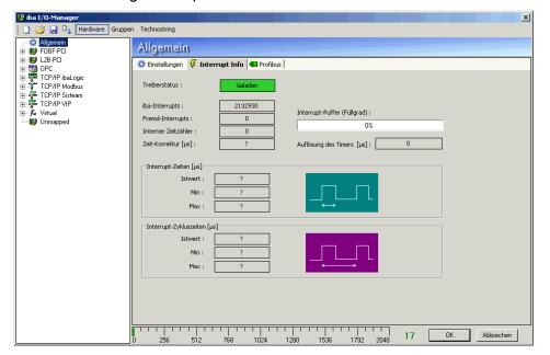
Auf der Link-Ebene (siehe 9.1.1), Register *Info*, lässt sich anhand der Baudrate kontrollieren, ob die Kommunikation mit dem ibaPADU funktioniert.
