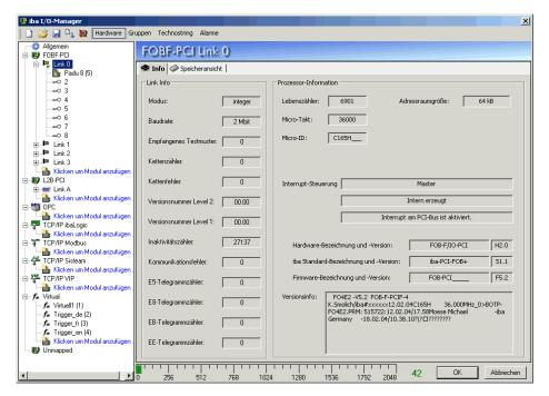
Wenn Sie den Link-Zweig weiter öffnen, sind die angeschlossenen Geräte (=Module) zu sehen. Jeder Link ist in Einheiten von acht Kanälen unterteilt, entsprechend der kleinstmöglichen Moduleinheit ibaPADU-8.
