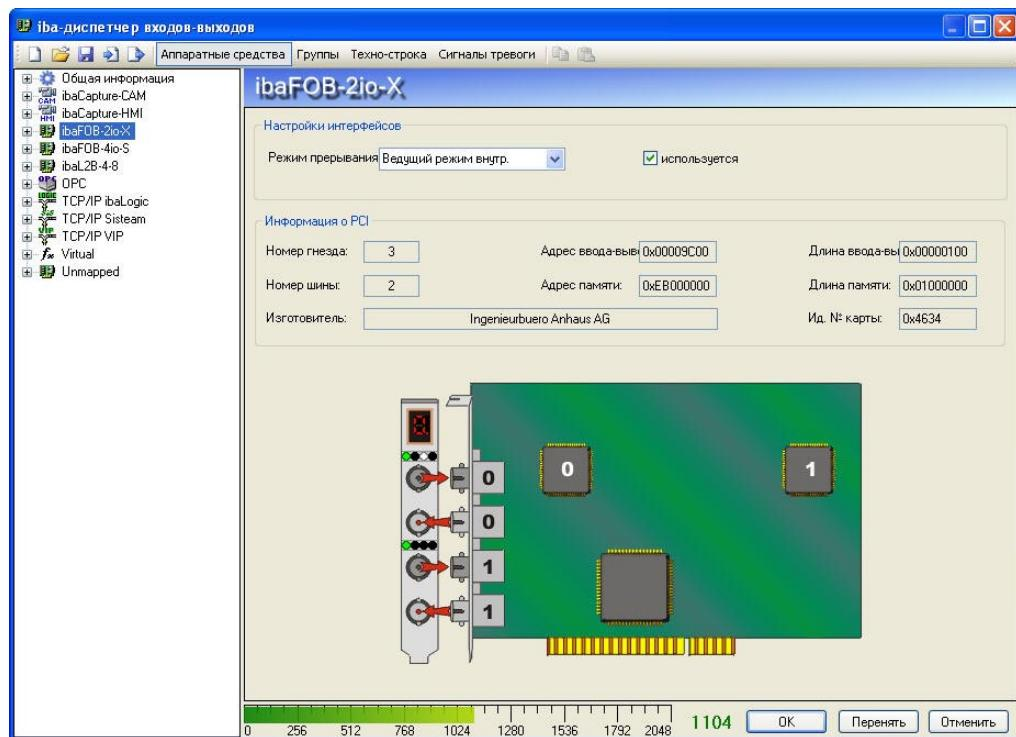
Соответствующий модуль схематически представлен в диалоговом окне, если выделено главное меню в дереве аппаратных средств слева. Здесь выполняются настройки модулей прерывания. Выделив меню Link, можно получить дополнительную информацию об отдельных Links и процессорах. При этом существует различная информация, в зависимости от того, работает ли Link в режиме "X", "F" или "M".
