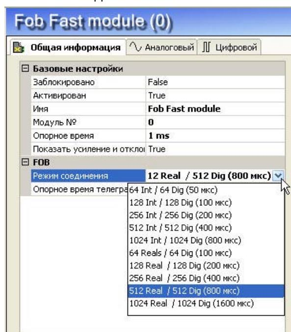
При выборе типа данных "Int/Real" выполняется автоматическая регулировка таблицы сигналов с аналоговыми значениями
