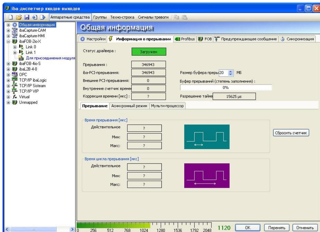
На уровне Link (см. 9.1.1) во вкладке "Информация" можно контролировать на основе скорости передачи данных в бодах, функционирует ли коммуникация с ibaPADU.
