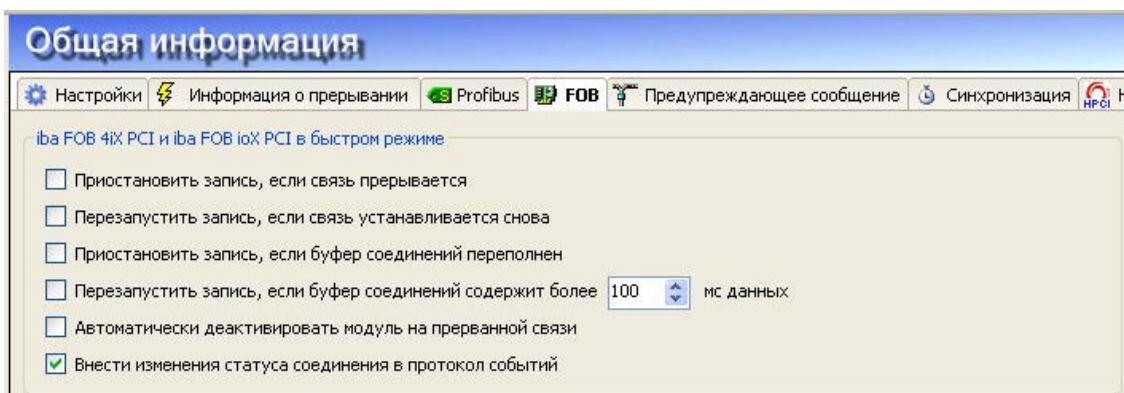
Имеющиеся там настройки действительны для соединений, сконфигурированных для быстрых измерений. При использовании карты в режиме "F" данные настройки не имеют значения.
